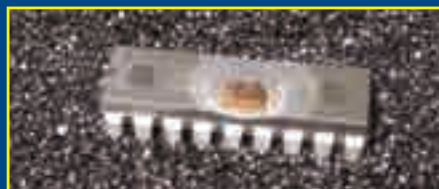
▲ Un comune integrato PIC dopo aver eroso il rivestimento esterno per mettere in vista il chip di silicio.
